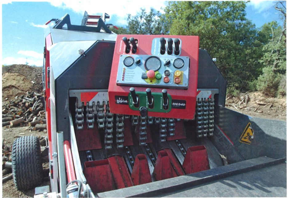
Der Einzug für die manuelle Beschickung mit Meterholz mit der Steuerungs- und Bedieneinheit. Die Bedienung der Maschine ist mit den nötigsten Hebeln und Schaltern so einfach wie möglich konzipiert. Der rote Notstopp-Knopf befindet sich in der Mitte der Bedieneinheit.
