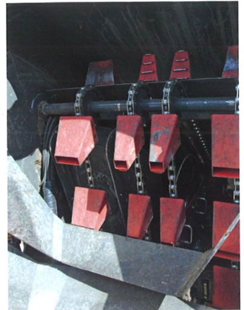
Das mit Klötzen versehene Förderband führt das Holz den Kreissägen zu. Die Meterholzstücke liegen lose auf den Klötzen auf, was auch bei krummem Meterholz eine reibungslose Schnittführung ohne Verkeilen oder Verklemmen gewährleistet.
