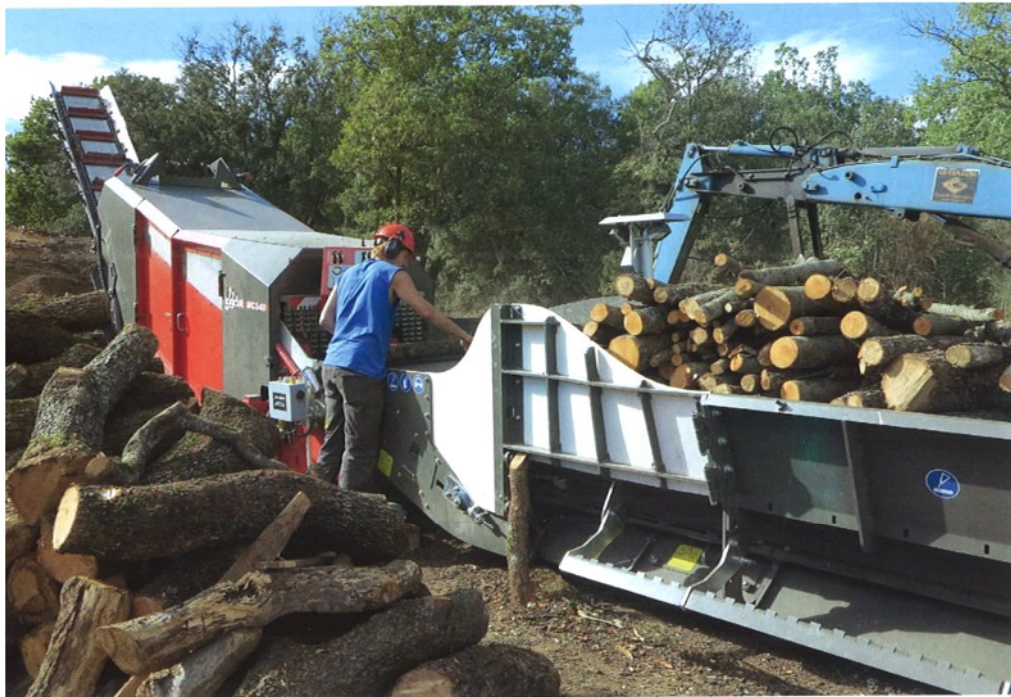
Die Beschickung der Brennholzsäge erfolgt manuell. An die Säge ist ein Zuführdeck mit Holzauflage und Beschickungsplattform angebaut. Die Länge der Holzauflage besteht aus Modulen mit jeweils einer Ladekapazität von einem Raummeter Meterholz.
